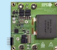
**EPC9153: 250 Wの高効率で薄型のバック・コンバータ**
